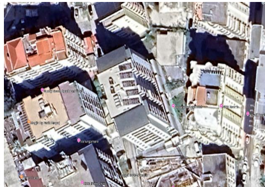
Fig 4: Fotografimi satelitor, ku duken depot e ujit të vendosura në soletën e katit të fundit
