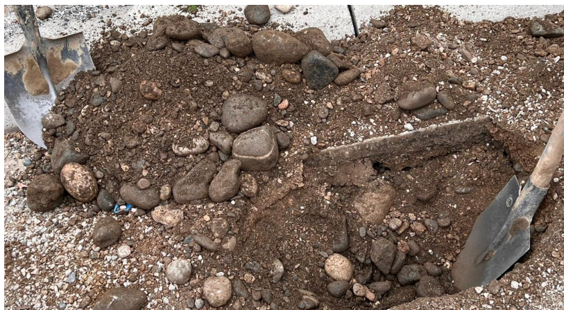
Fig. 3 Verifikimi i fraksioneve të zhavorrit
